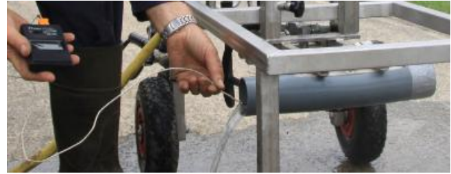
Figuur 14. Temperatuurbepaling via opvangcilinder ter hoogte van de uitstroomlijn (De Cauwer, 2013c).
